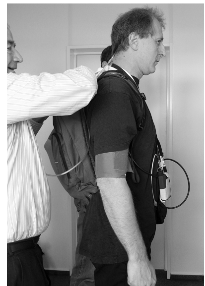
Bild 2. Proband mit Nasenbrille, Sauerstoffflasche im Rucksack und Messgeräten zur Aufnahme von medizinischen Daten.
