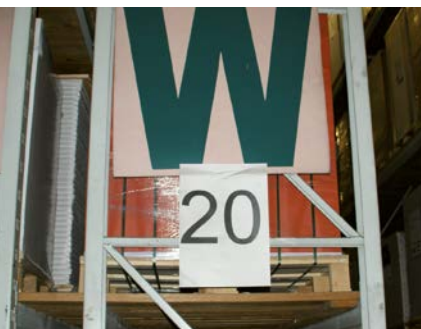
Abb. 15 zu tief eingelagerte Palette führt zu einer Überlastung der inneren Stützen und Trägern
