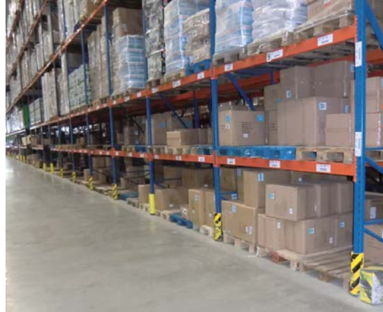
Abb. 19 Stützenschutz an allen Stützen
