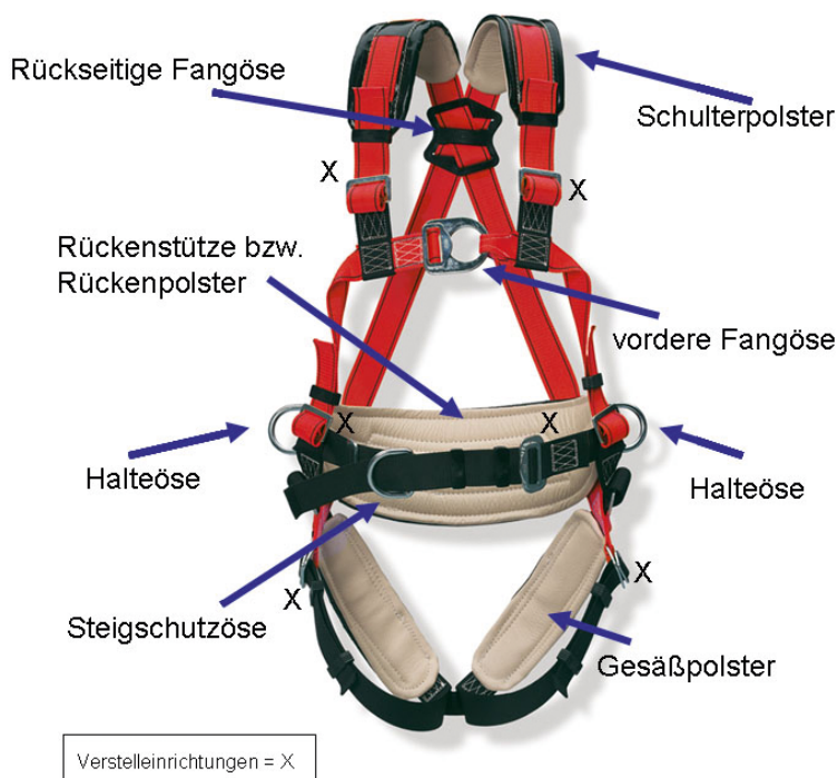
Bild 10: Beispiel eines Auffanggurtes mit vorderer und rückseitiger Auffangöse, seitlichen Halteösen und einer Steigschutzöse. Der Gurt ist zusätzlich mit Schulter-, Beingurt, und Rückenpolstern ausgestattet
