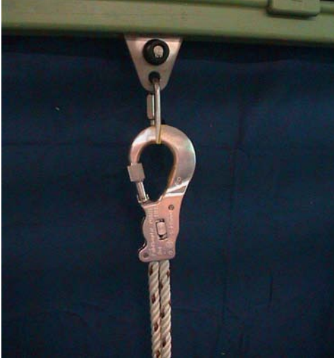
Bild 31: Anschlageinrichtung mit horizontaler Führungsschiene und beweglichem Anschlagpunkt
