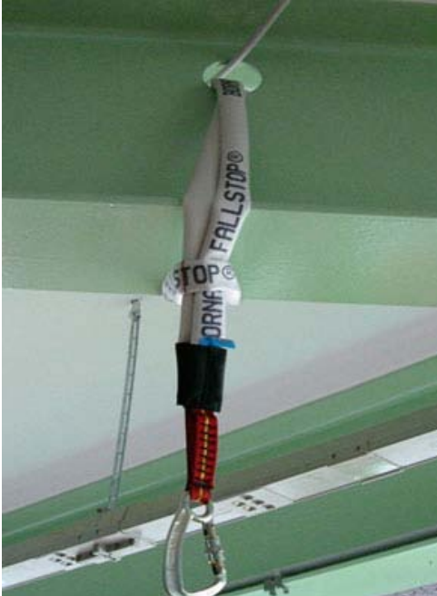
Bild 33: Beispiele für die Verwendung einer Bandschlinge als Anschlaghilfe
