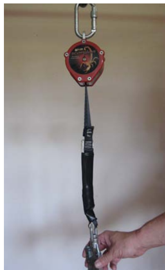
Bild 19: Höhensicherungsgerät mit Verbindungsmittel aus Gurtband
