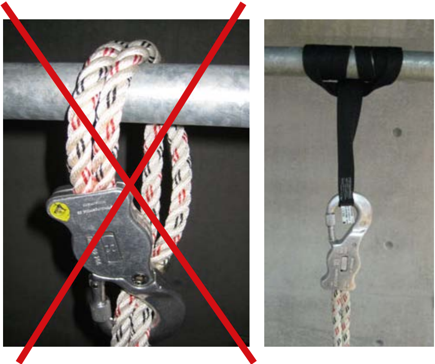
Bild 36: Richtiges Anschlagen: Zur Erhaltung der Funktionsfähigkeit des Reibungsfalldämpfers wird eine Bandschlinge als Anschlaghilfe verwendet
