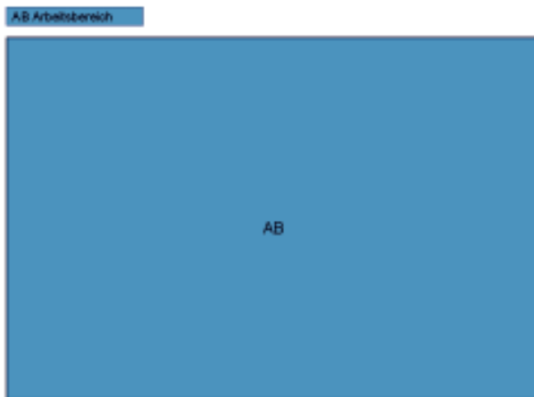
Bild 2: Prinzipskizze zum Beleuchtungskonzept „Raumbezogene Beleuchtung“. Der gesamte Raum wird als ein Arbeitsbereich betrachtet.
