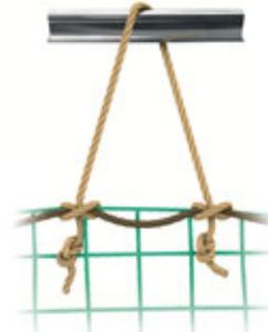
Seile sind gegen Aufdrehen zu sichern und dürfen durch scharfe Kanten nicht beschädigt werden können. ④
