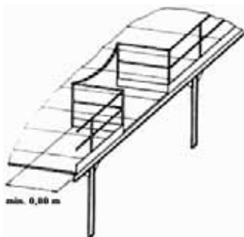
Abb. 11: Beispiel eines eingezogenen Abstellplatzes
