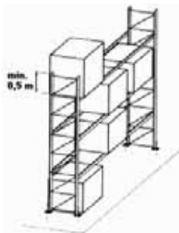
Abb. 7: Beispiel einer Sicherung gegen seitliches Herabfallen der Ladeeinheiten
