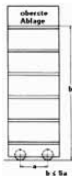
Abb. 12: Verhältnis Radachsenabstand zu Höhe der obersten Ablage bei verfahrbaren Regalen und Schränken
