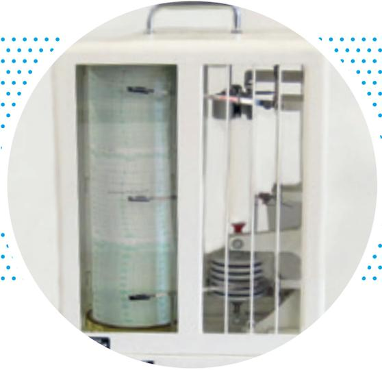
Thermohygrograph zur Messung von Lufttemperatur und relativer Luftfeuchtigkeit.
