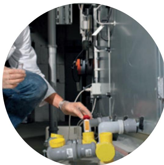
Kontrolle der Keimbelastung mittels Dip Slides
