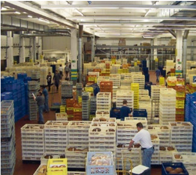
Abb. 2 Backwarenverteilzentrum Gestapelte heiß-warme Backwaren geben Wärme und Feuchte an die Raumluft ab
