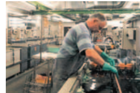
Bild 2-1: Handbeschickung an einem Silberbad
