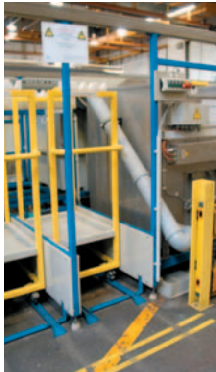
Bild 3-5: Berührungslos wirkende Schutzeinrichtungen findet man an den Bestückungs- und Entladestationen von Galvanoautomaten
