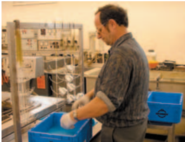
Bild 8-1: Befestigen der Werkstücke auf Warenträgern. Die Handschuhe werden hier auch zum Schutz der polierten Oberflächen verwendet
