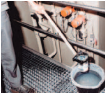
Bild 1-1: Vom Betrieb selbst hergestelltes Probenahmegerät
